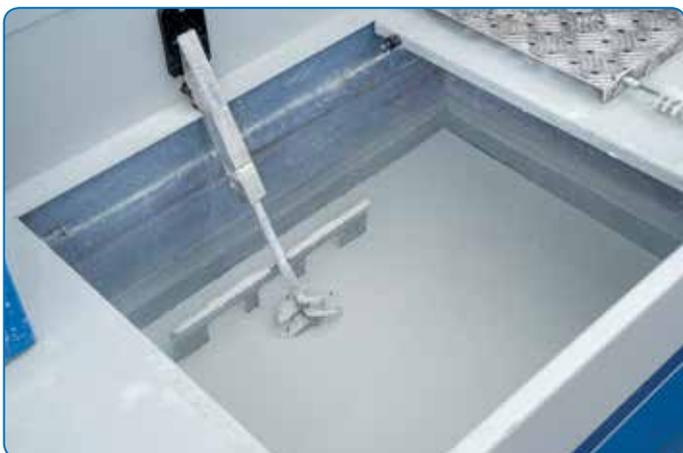
Feststoffe und klares Wasser sind getrennt. Die Einleitung in den Abwasserkanal durch das Filtersystem darf nun erfolgen.
